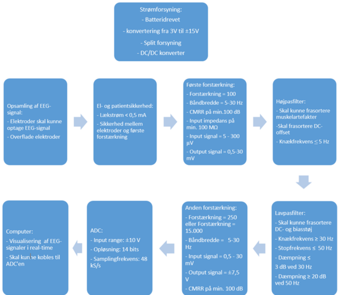
Figur 5.3: Figuren viser et diagram over systemets blokke og tilhørende krav.
